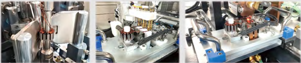
無人機馬達自製類產線 - 定子繞線、測試及線圈端部焊接
